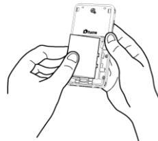
4. Закройте крышку батареи. Поместите крышку примерно на 5 мм ниже позиции закрытия. Сдвиньте крышку вверх. Убедитесь, что она автоматически заблокировалась. (Рисунок 4)
